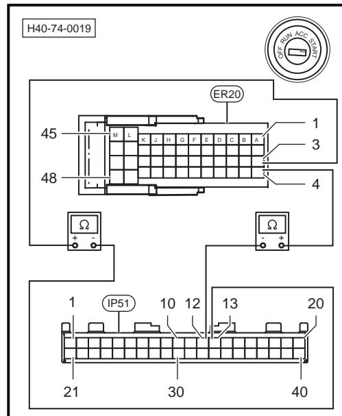
6. 连接网关控制器IP51插头、自动变速器控制单元ER20插头和组合仪表IP14插头。
