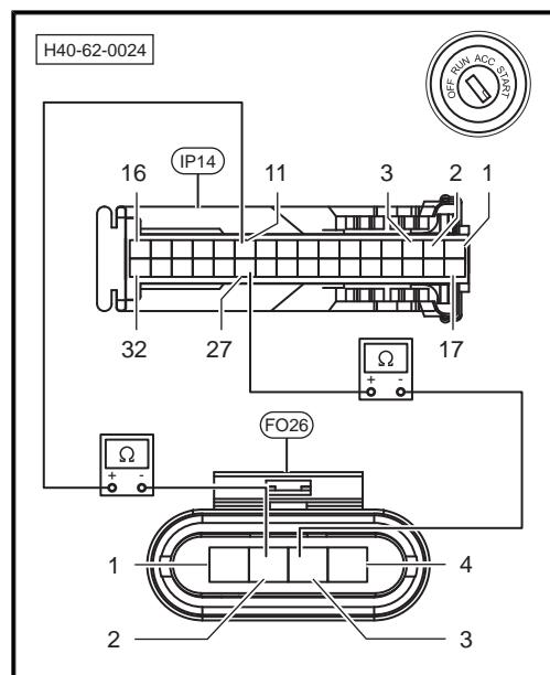
7. 测量燃油泵FO26插头2针脚和FO26插头3针脚与车身接地之间是否短路。
