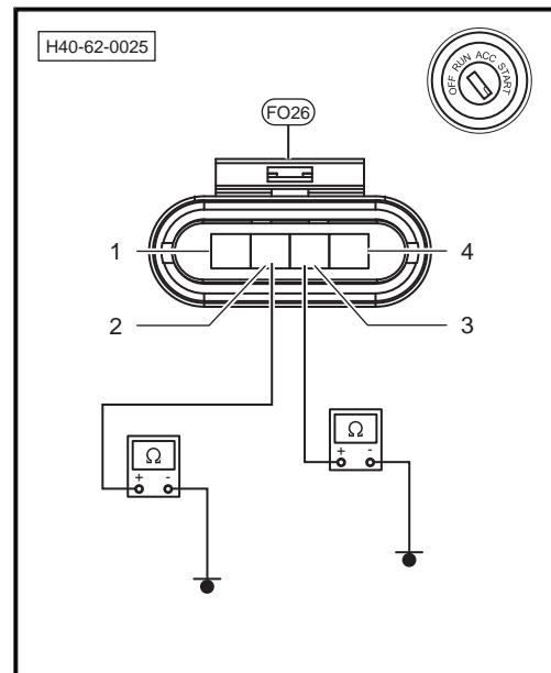
8. 测量燃油泵FO26插头2针脚和FO26插头3针脚与蓄电池正极之间是否短路。
