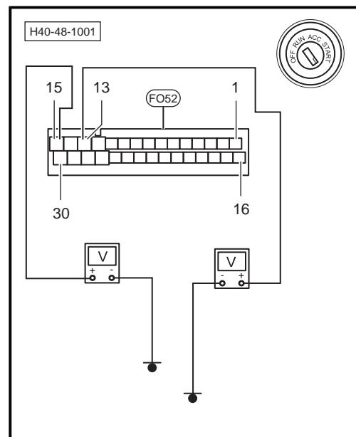
8. 测量EPB控制单元FO52插头28针脚和FO52插头30针脚与车身接地之间是否导通。
