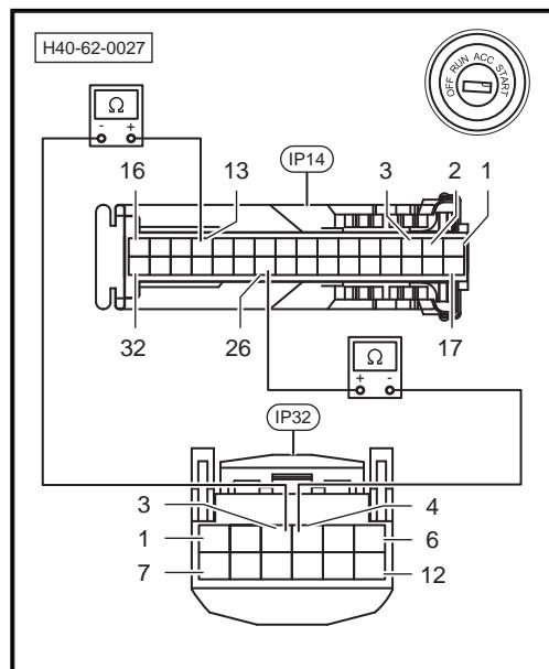
4. 测量组合仪表IP14插头13针脚和IP14插头26针脚与车身接地之间是否短路。
