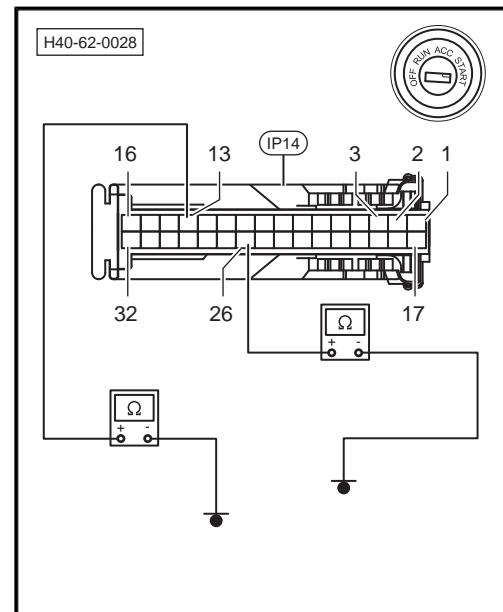
5. 连接组合仪表IP14插头和时钟弹簧IP32插头。
