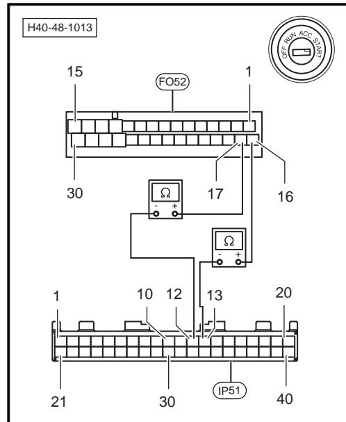
4. 测量组合仪表IP14插头15针脚和IP14插头16针脚与网关控制器IP51插头18针脚和IP51插头17针脚之间导线是否导通。
