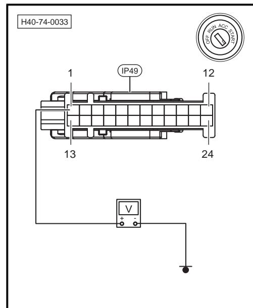
9. 测量安全气囊控制器IP49插头15针脚与车身接地之间是否导通。
