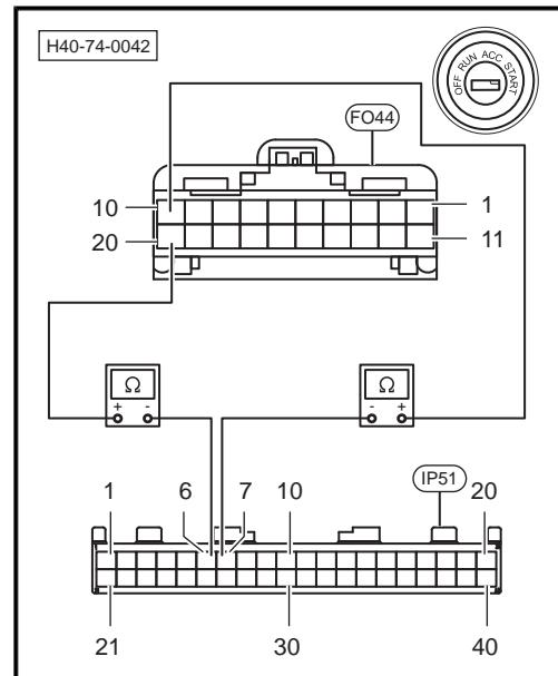
6. 连接网关控制器IP51插头、无钥匙启动系统控制单元FO44插头和FO45插头和组合仪表IP14插头。
