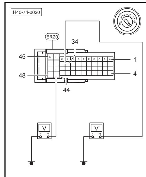
9. 测量自动变速器控制单元ER20插头45针脚和ER20插头48针脚与车身接地之间是否导通。
