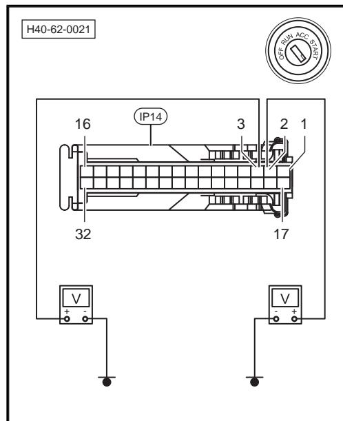
6. 测量组合仪表IP14插头1针脚与车身接地之间导线是否导通。
