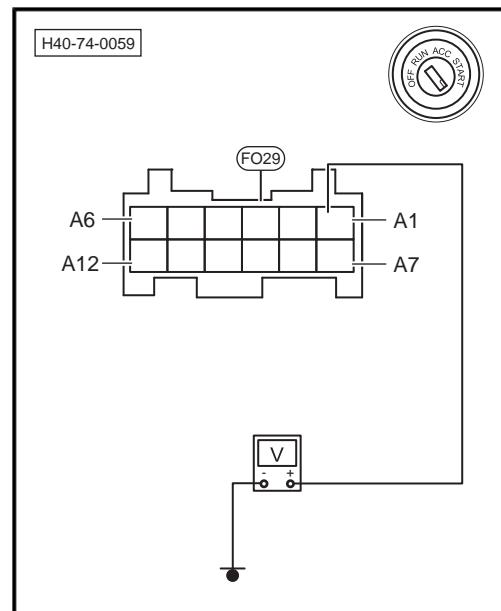
9. 测量倒车雷达控制单元FO29插头A7针脚与车身接地之间是否导通。
