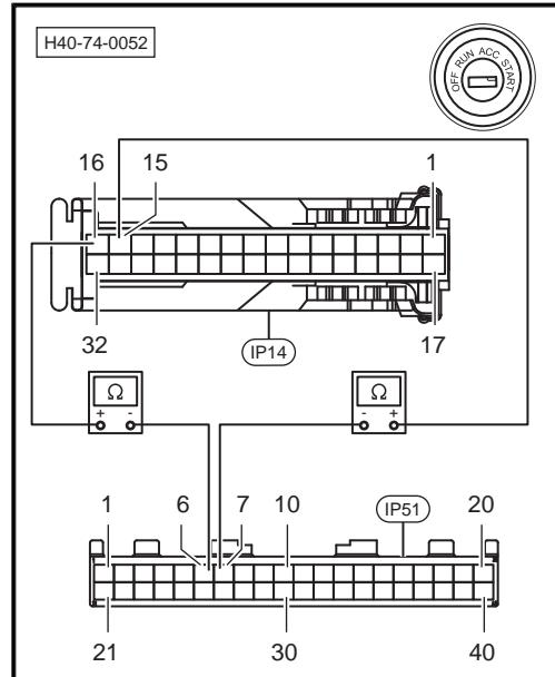
4. 断开自动变速器控制单元ER20插头，检查是否有裂痕和异常，针脚是否腐蚀、生锈。
