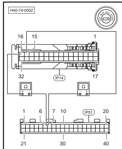
4. 断开无钥匙启动系统控制单元FO44插头和FO45插头，检查是否有裂痕和异常，针脚是否腐蚀、生锈。
