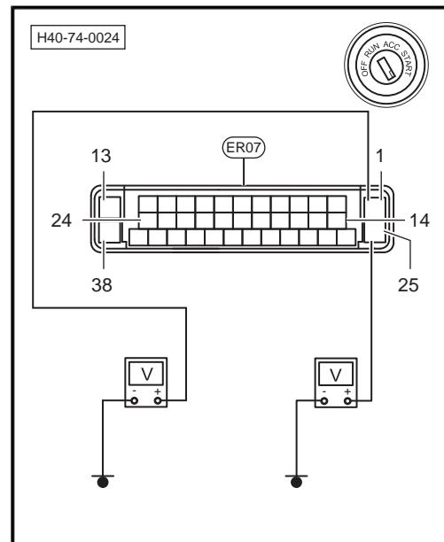
9. 测量ESP控制单元ER07插头13针脚和ER07插头38针脚与车身接地之间是否导通。
