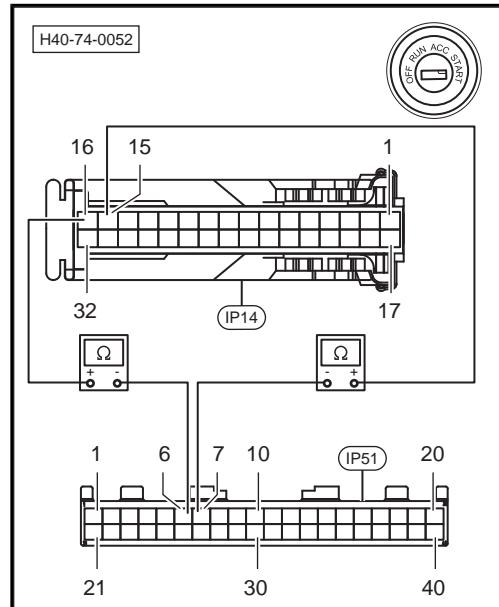
4. 断开网关控制器IP51插头和电子转向锁IP30插头，检查是否有裂痕和异常，针脚是否腐蚀、生锈。
